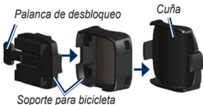
**Para manillares horizontales:** separe y retire la parte superior del soporte, gírela 90 grados y vuelva a colocarla. Continúe con el paso 2.
